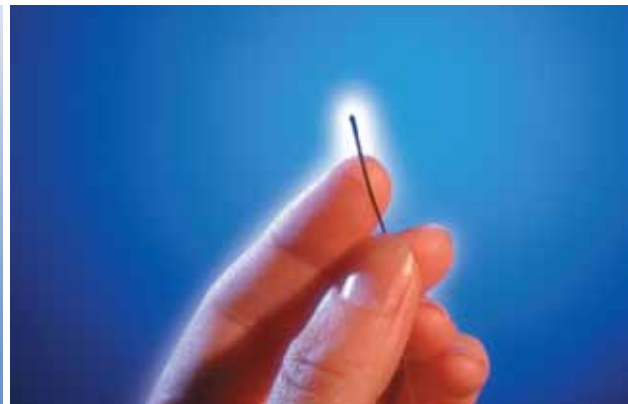
microMOSFET da 1 mm per misurazioni in zone ad alto gradiente
