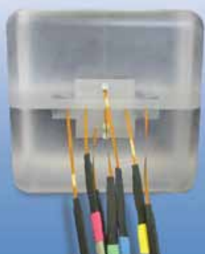
Fantoccio XWU-IMRT per dosimetria 3D con MOSFETs
